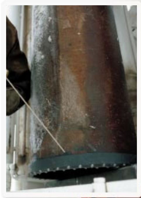
La zapata patentada soldada al revestimiento corta a través de rocas y también concreto reforzado con acero.
