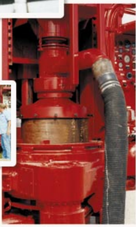
El separador de descarga dirige el detritus a un punto seguro o un ciclón opcional de muestras.
